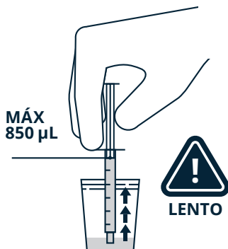
Figura 1. Extraiga 850 µL de la muestra.
